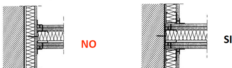
Figura 20 – strutture a secco, dettaglio esecutivo dei nodi a T
