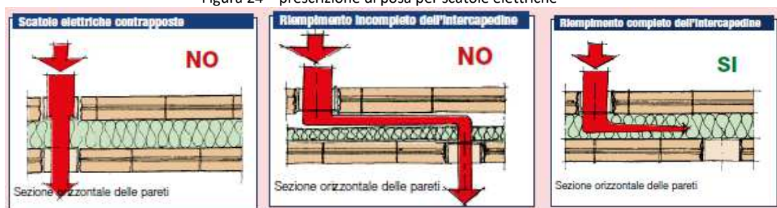
Figura 24 – prescrizione di posa per scatole elettriche
