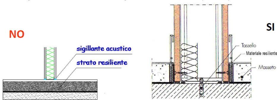
Figura 22 – strutture a secco, dettaglio esecutivo del nodo fra parete e pavimento
